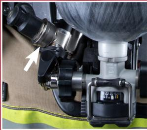
DE FÁCIL ACCESO, PIVOTANTE, CONECTOR RIC UAC CONECTOR CERCA A LA VÁLVULA DEL CILINDRO. EL RIC UAC ES USADO DURANTE EMERGENCIAS CUANDO SE DEBE CARGAR EL CILINDRO.
