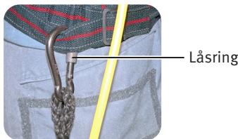
3. Kontrollera att luftförsörjningsslängen är trycksatt. Anslut snabbkopplingen på P+ regulatorn till andningsapparaten. För versioner med Interspiro snabbkoppling, lås den med en låsring.
